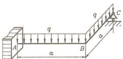
10、图示结构  $B$ 、 $C$  为球铰，材料均为 A3 钢。梁  $AB$  为圆截面，杆  $BC$  为矩形截面，已知： $[\sigma] = 160 \text{ MPa}$ ； $E = 200 \text{ GPa}$ ， $\sigma_p = 200 \text{ MPa}$ ，临界应力直线经验公式为  $\sigma_{cr} = 304 - 1.12\lambda \text{ (MPa)}$ ， $n_{st} = 3$ ， $d = 100 \text{ mm}$ ， $l = 2 \text{ m}$ ， $a = 1 \text{ m}$ ， $h = 48 \text{ mm}$ ， $b = 24 \text{ mm}$ ，试按  $AB$  梁的强度和  $CB$  杆的稳定性确定结构的许可均布载荷  $[q]$ 。
