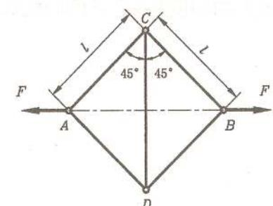
8、等截面刚架如图所示，各杆的弯曲刚度  $EI$  相同。试计算截面  $A$  的垂直位移  $\Delta_{Ay}$ （不计轴力和剪力对变形的影响）。
